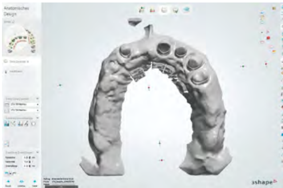
Abb. 8: Im Doppelscanverfahren erzeugtes virtuelles Modell des Oberkiefers.
