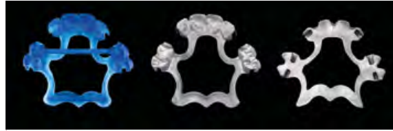
Abb. 15: Die Modellgusskonstruktion wird erst additiv hergestellt und dann in CoCr gegossen. Alternativ ist die direkte Herstellung im Lasermelting-Verfahren möglich.
