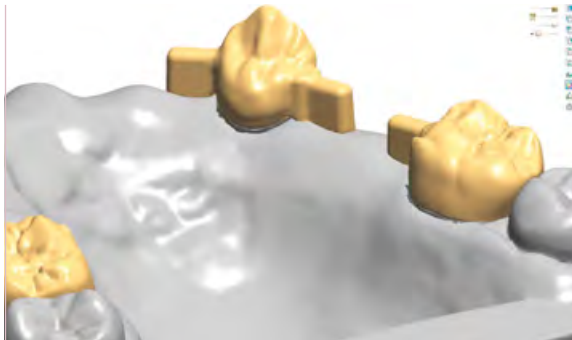
Abb. 13: Computergestützte Konstruktion der Sekundärkronen.
