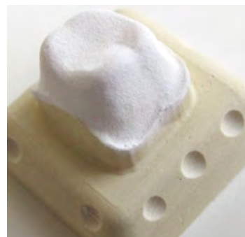
Abb. 3: Einzelstumpf mit einer Schicht herkömmlichem Scanspray.
